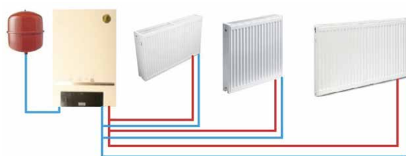
Schematische weergave van centrale verwarming
